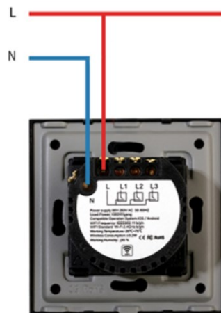
2 pav. Kito (nepagrindinio) jungiklio prijungimo schema
